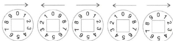
No medidor de ponteiros, inicie a leitura da direita para a esquerda
